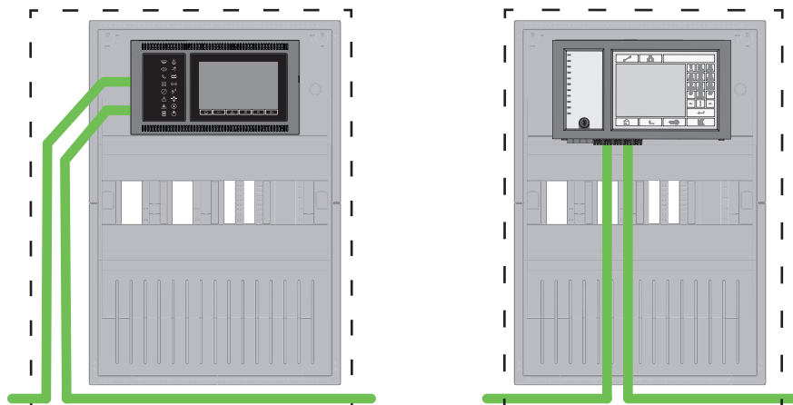
Afbeelding 7.2: Centralenetwerk via CAN
