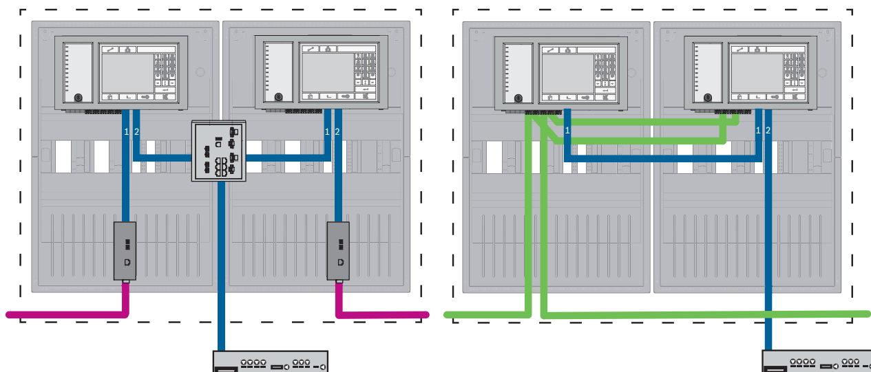
Afbeelding 7.10: Linkerzijde: in Ethernet-netwerk, rechterzijde: in CAN-netwerk
